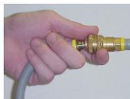
Después de jalar la manga, el niple se moverá fuera del cople ligeramente. Siga manteniendo la manguera y la manga del acople hasta que el aire en la manguera esté totalmente agotado.
