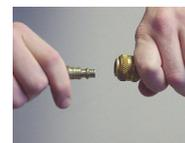
Después de que la línea está totalmente agotada de aire, usted ahora puede separar con toda seguridad el niple del acople.
