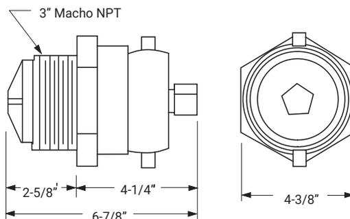
Bajo ninguna circunstancia un reductor check debe ser instalado directamente en la tubería, esto prevendrá al reductor abrirse. Instale directamente en el soporte apropiado solamente
