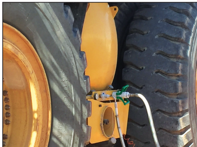
Llenado de combustible de GNL en sitio de un camión para mina
